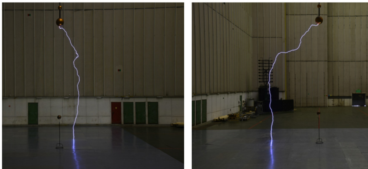
Fot. 5.1 Wyładowanie będące następstwem uderzenia łączeniowego biegunowości ujemnej
